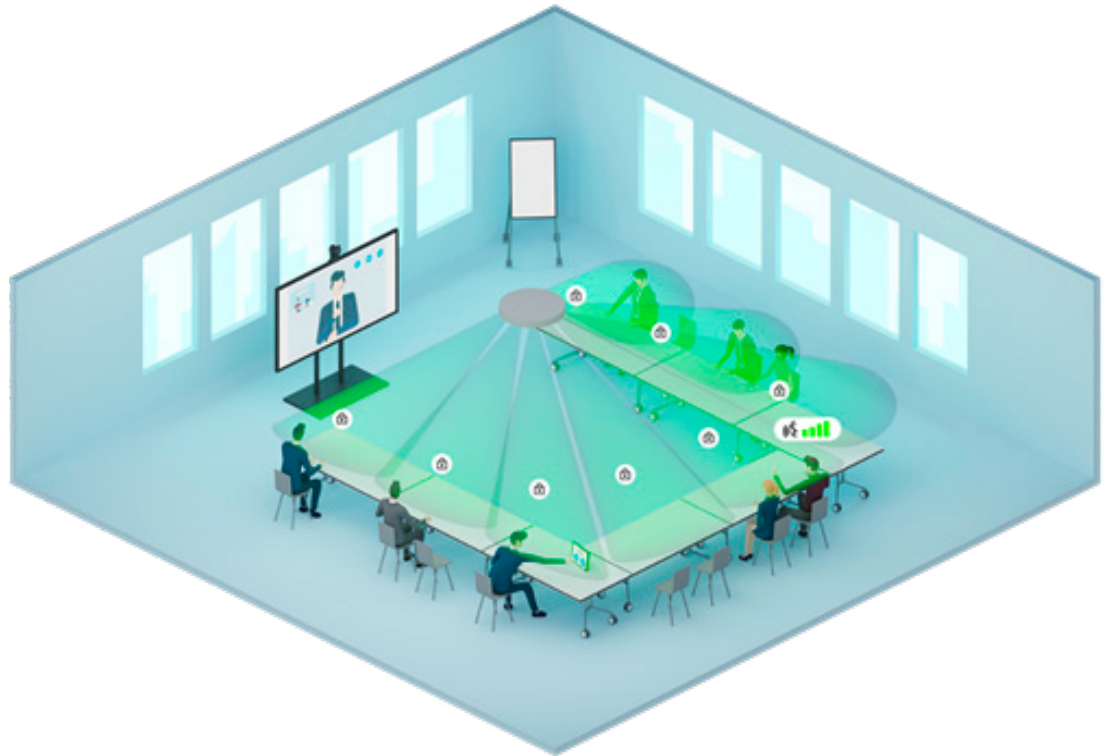
Deckenmikrofon mit mehreren Beamforming-Zonen
